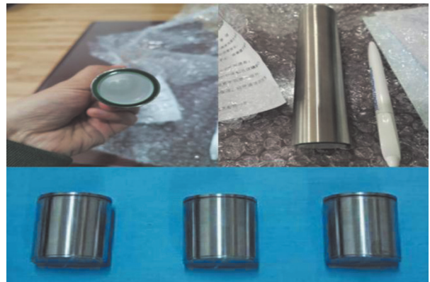
图 6 封装后 NaI(Tl) 闪烁体探测器 Fig.6 NaI (Tl) scintillator detector after packaging
