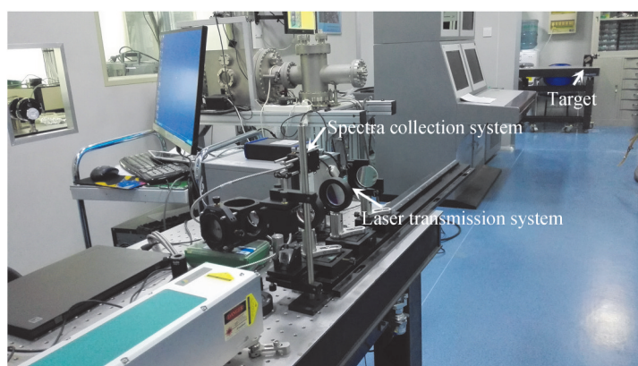
图 5 5 m 处远程 LIBS 实验装置图
