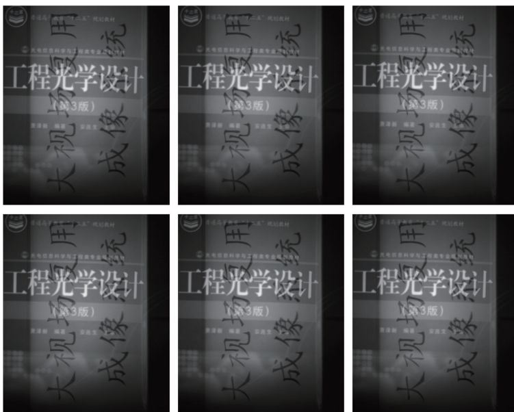
图5 六幅具有通道间不同偏移量的混叠图像 Fig.5 Six superimposed images with different relative shifts
