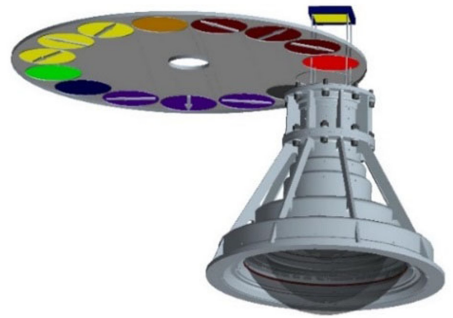
图 1 DPC 成像系统结构示意图 Fig.1 Structure diagram of DPC imaging system
