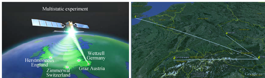
图10 欧洲多望远镜激光测距(Graz; Zimmerwald: 600 km; Wettzell: 400 km; Herstmonceux: 1 200 km)
