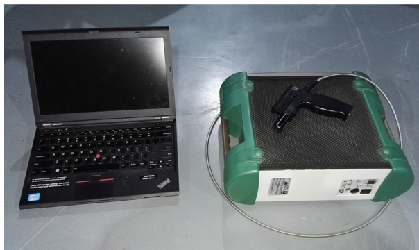
图10 ASD 光谱辐射计实物图
