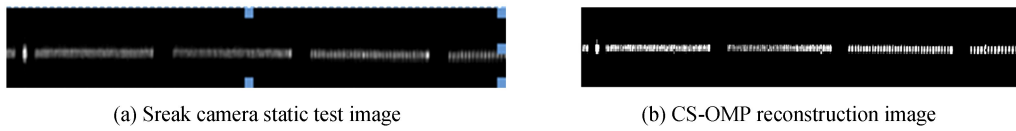
图4 条纹管 CS-OMP 重构图与原图比较 Fig.4 Comparison of streak camera static test image and CS-OMP reconstruction image
