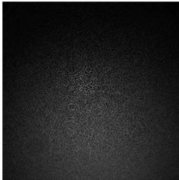
图 7 双焦点光子筛在 CCD 处的全息图 Fig.7 The hologram of bifocal photon sieve at the CCD
