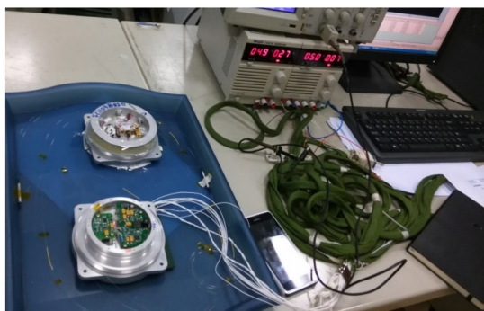
图4 光程倍增光纤陀螺零偏实验图
