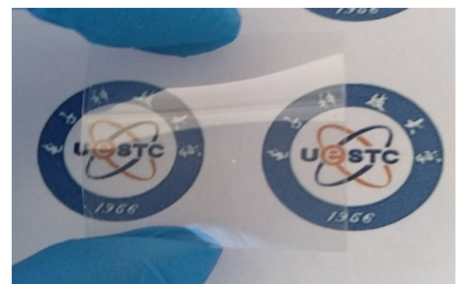
图 3 基于 PET 衬底的纳米银线薄膜实物图 Fig.3 Image of Ag NWfilms on PET substrate
