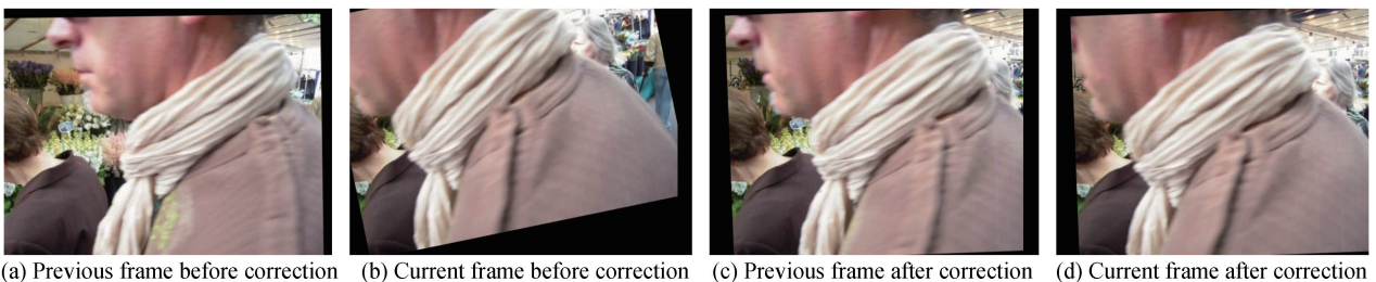
图 4 大运动前景下仿射变换矩阵修正前后的相邻两帧的对比
