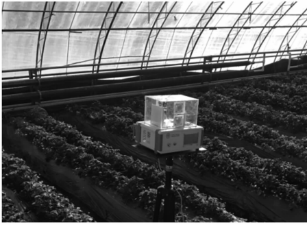
图 10 CO 2 传感器节点在温室大棚中的测试现场图 Fig. 10 Site map of CO 2 sensor node in greenhouse
