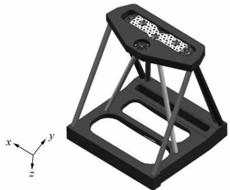
图 2 光机结构简图 Fig. 2 Structure of space camera
