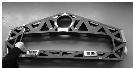
图 9 结构件自由模态测试
