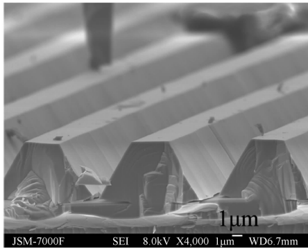
图 1 沿[1-100]方向生长的 InGaN/GaN 条纹多量子阱 SEM 剖面图
