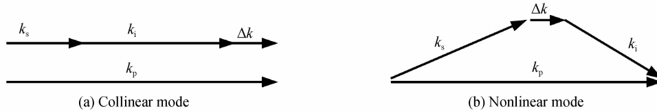
图2 共线和非共线模式相位匹配示意图
