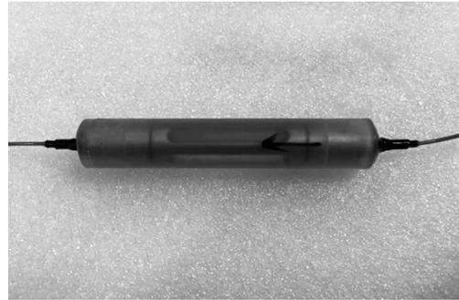
图 9 加固后水听器的原型样品
