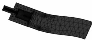
图 5 加固封装水听器的一阶振型
