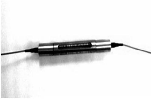
图 8 未加固水听器的原型样品
