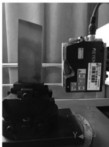
图 8 90^\circ 叶片测量位置关系图 Fig.8 90^\circ measuring position of blade
