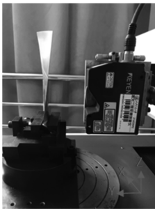
图 6 0^\circ 叶片测量位置关系图 Fig.6 0^\circ measuring position of blade
