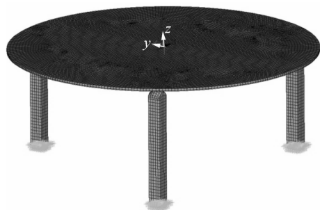
图2 三点能动支撑单压电变形镜网格划分
