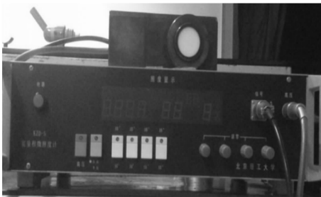
图 5 KZD-5 型宽量程微照度计 Fig. 5 KZD-5 low illumination meter
