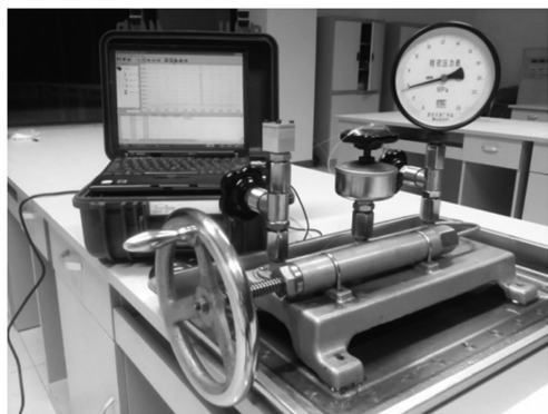
图 11 压力传感器标定实验装置
