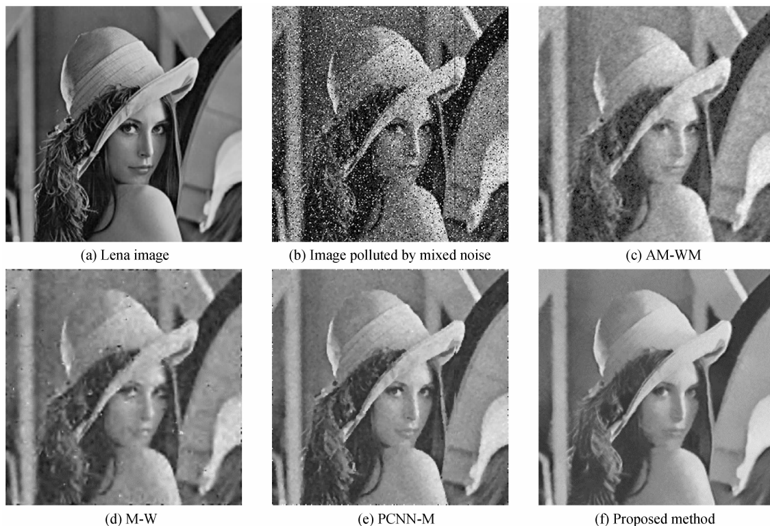
图 2 受混合噪声污染 ( \sigma = 20, \rho = 0.2 ) 的 Lena 图像去噪结果
