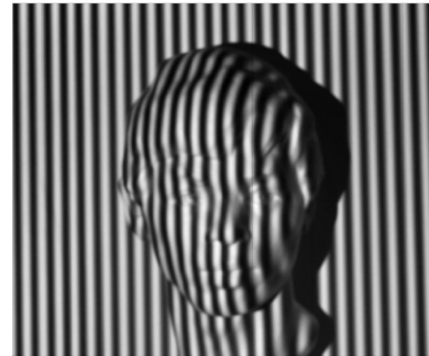
图8 采集的变形条纹图像 Fig. 8 Deformation fringe image from CCD
