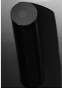
图 1 挤压法制备的 \text{Ge}_{20}\text{Te}_{20}\text{Se}_{60}/\text{Ge}_{20}\text{Se}_{80} 预制棒 Fig. 1 \text{Ge}_{20}\text{Te}_{20}\text{Se}_{60}/\text{Ge}_{20}\text{Se}_{80} preform prepared by extrusion method
