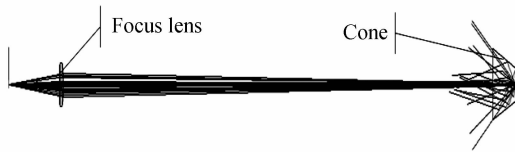
图 5 荧光带聚光锥罩和探测器接收光路 Fig. 5 Schematic of ray collection
