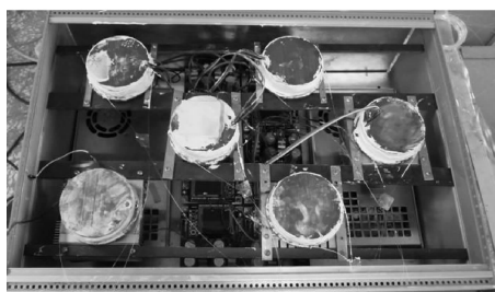
图 2 用 TEC 控制的温度标定铜块
