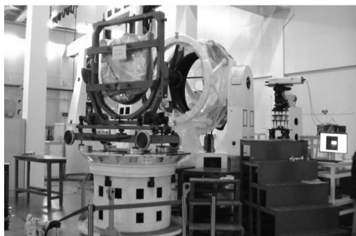
图 8 主光学系统的检测 Fig. 8 The test of POS
