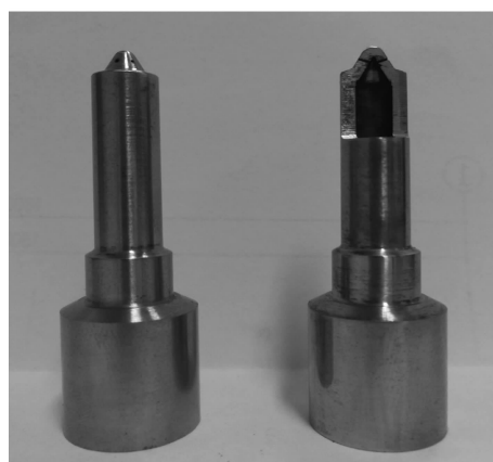
图 3 喷油嘴加工实物剖面
