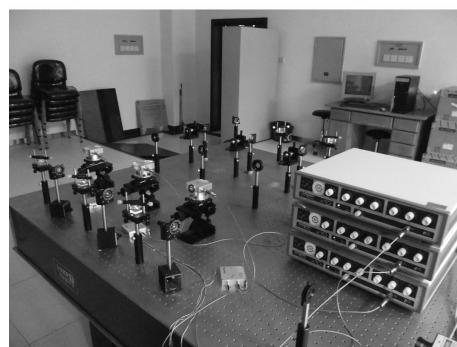
图 4 三光束傅里叶望远镜成像实验照片
