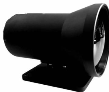
图 15 大视场透射式红外平行光管实物图
