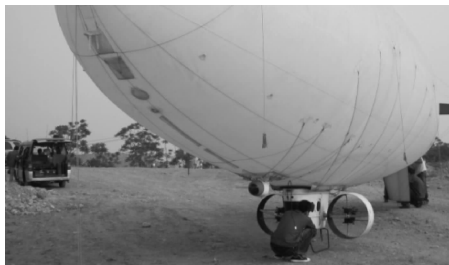
图1 电视导引头在飞艇上的安装
