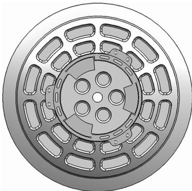
图 2 反射镜及支撑结构
