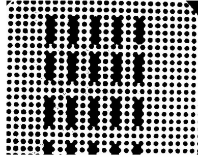
图 5 OTSU 法处理后焊点图像 Fig. 5 The X-ray digital image after OTSU threshold segmentation
