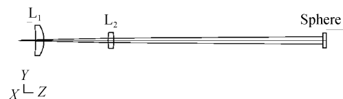
图3 补偿器整体组件的检测
