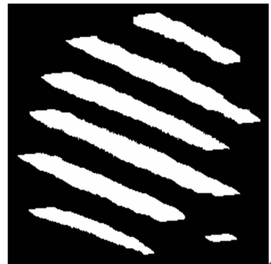
图 7 形态学处理的效果 Fig. 7 Fringes after morphological processing
