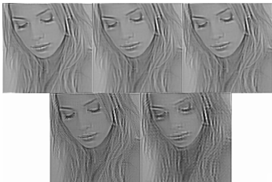
图 11 不同采样间隔的对焦面图像 Fig. 11 Refocused images at different sampling intervals
