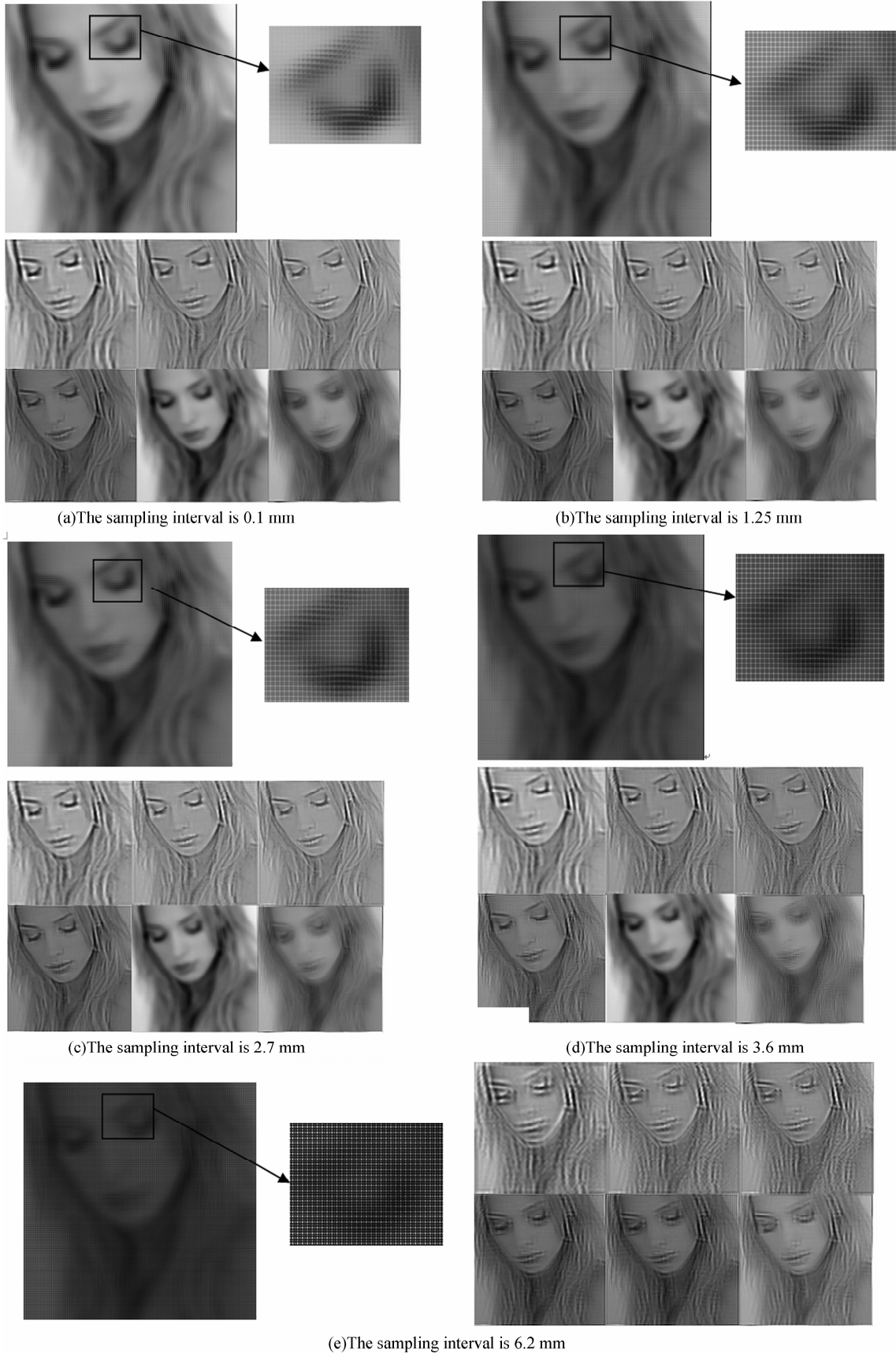
图 9 采样间隔为 0.1 mm、1.25 mm、2.7 mm、3.6 mm 和 6.2 mm 时的光场图像
