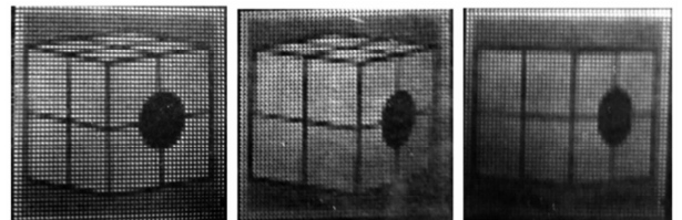
图 7 实验拍摄的全视差全息图照片
