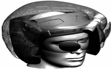
图2 护目镜型头盔显示器安装位置 Fig. 2 Mounting position of HVD
