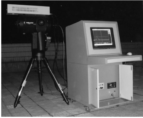
图1 米散射激光雷达系统
