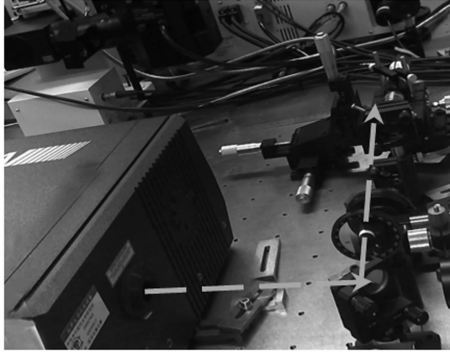
图1 飞秒激光在 PCF 中的传输及超连续谱产生装置 Fig.1 Setup for the supercontinuum generation in PCF
