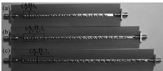
图 3 一维光子晶体 (AB)_8 (a)、 (A_2B_2)_5 和 (A_3B_3)_4 的照片 Fig. 3 Photographs of the fabricated photonic crystals (AB)_8 , (A_2B_2)_5 and (A_3B_3)_4 respectively
