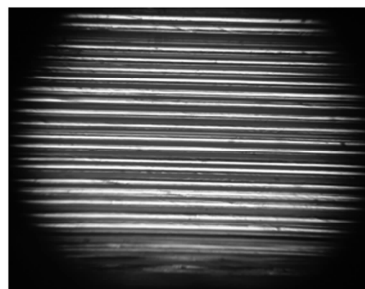
图 5 光纤纵截面的光栅效应
