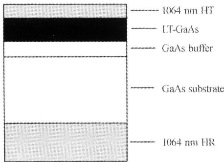
图1 低温 GaAs 吸收体制作结构
