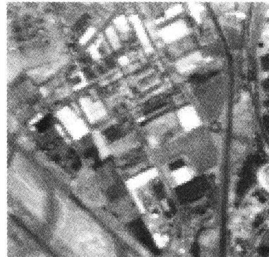
图 5 RBF 网络多光谱融合复原结果 Fig. 5 The restoration image with RBF Network
