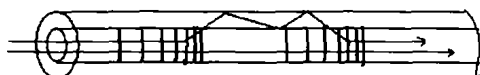
图 3 两个级联的长周期啁啾光纤光栅的 Mach-Zender 干涉原理 Fig. 3 Mach-Zender interference principle of two cascaded long period fiber grating
