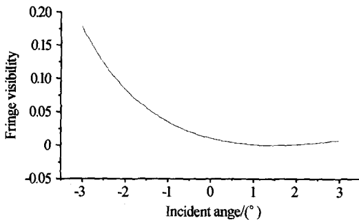
图3 方位角为零度时, 条纹相衬度随入射角的变化关系 Fig. 3 Fringe visibility vs. incident angle \varphi' = 0^\circ
