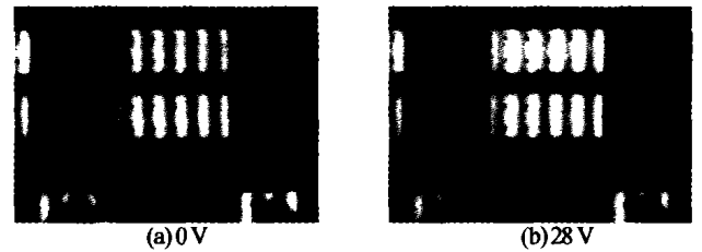
图 3 投影到微镜上的条纹图 Fig. 3 The fringe patterns projected on the micro-mirror
