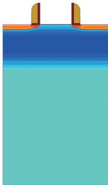
图 5 6T CIS 传输栅单管 MOS 结构仿真模型
