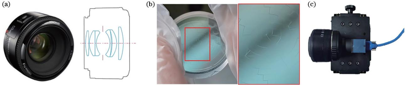
图 15 相位板与成像系统图。(a)永诺 YN50 mm F1.8 标准定焦镜头;(b)加工好的环式双螺旋相位板;(c)双螺旋编码成像实物系统
