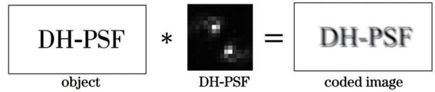
图 3 DH-PSF 编码成像过程示意图
