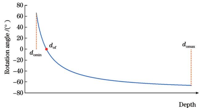
图 7 DH-PSF 旋转角度与深度之间的关系
