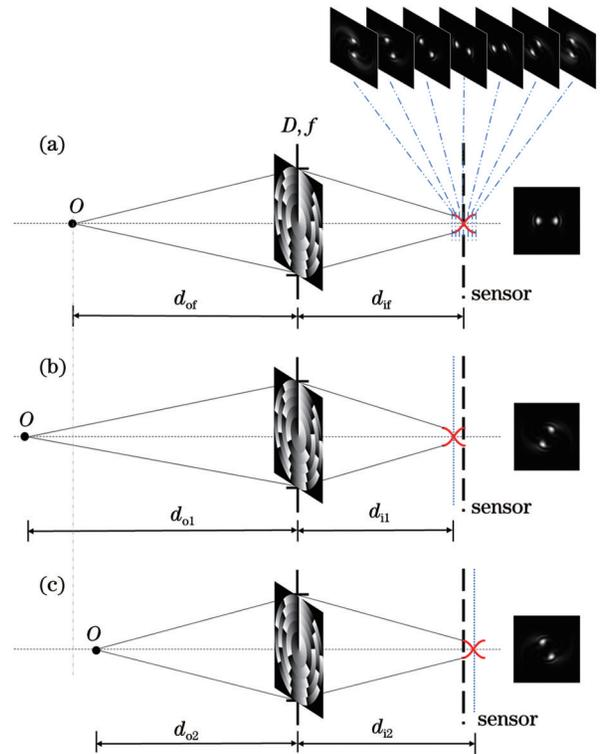
图 1 双螺旋相位编码成像系统示意图。(a)无离焦;(b)负离焦;(c)正离焦
