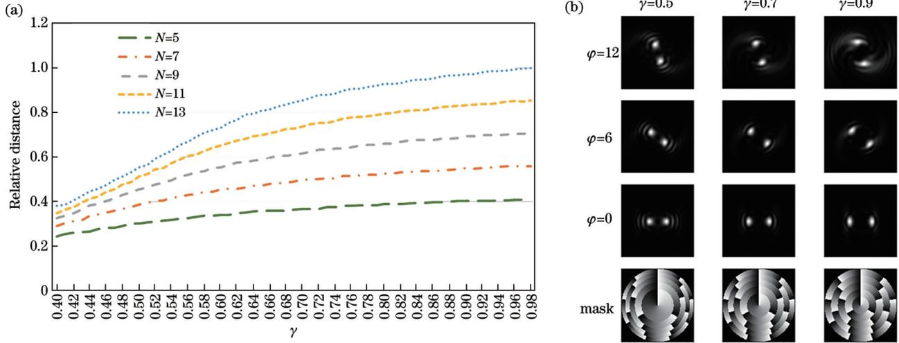
图 6  $\gamma$  对成像特性的影响。(a) 不同环数的双螺旋相位板在对焦时两主瓣间的相对距离与  $\gamma$  之间的关系; (b) 不同  $\gamma$  值的五环双螺旋相位板在不同离焦下的 DH-PSF
