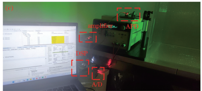
图 6 UWOC 系统的实验装置和实验现场图。(a)发送端;(b)实验的水箱环境;(c)接收端
