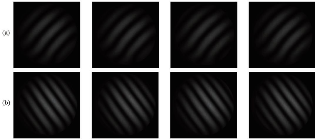
图 11 不同平行平板的 4 幅连续的空腔干涉采样图。(a) 40 mm 平行平板; (b) 5 mm 平行平板
